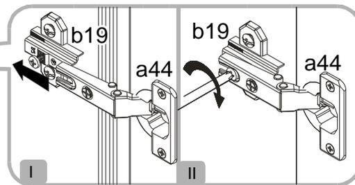
**Regulacja drzwi /Seřizování frontálních dílů**
