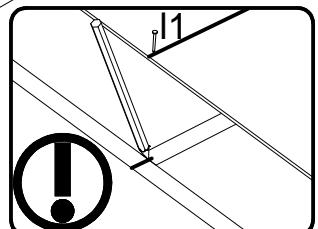
**PL** Przymocować segment do ściany. Niewłaściwe zamocowanie mebla grozi przewróceniem (zerwaniem) mebla podczas użytkowania.
