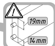
**PL** Złożyć segment zgodnie z rysunkiem i połączyć złączem mimośrodkowym **r1**, używając do tego celu kluczyka **z1**.
