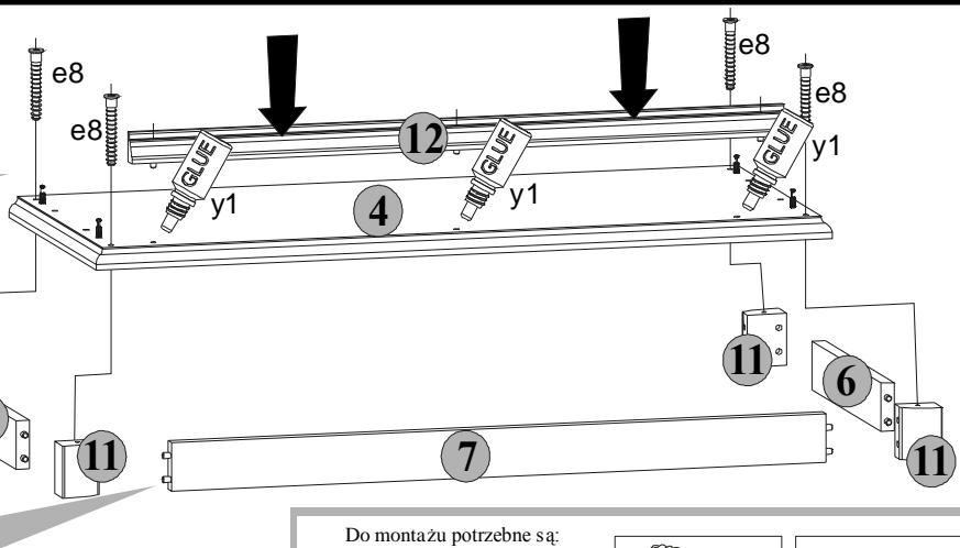
**PL** Złożyć segment zgodnie z rysunkiem i połączyc złączem mimośrodowym *rI*, używając do tego celu kluczyka *zI*.
