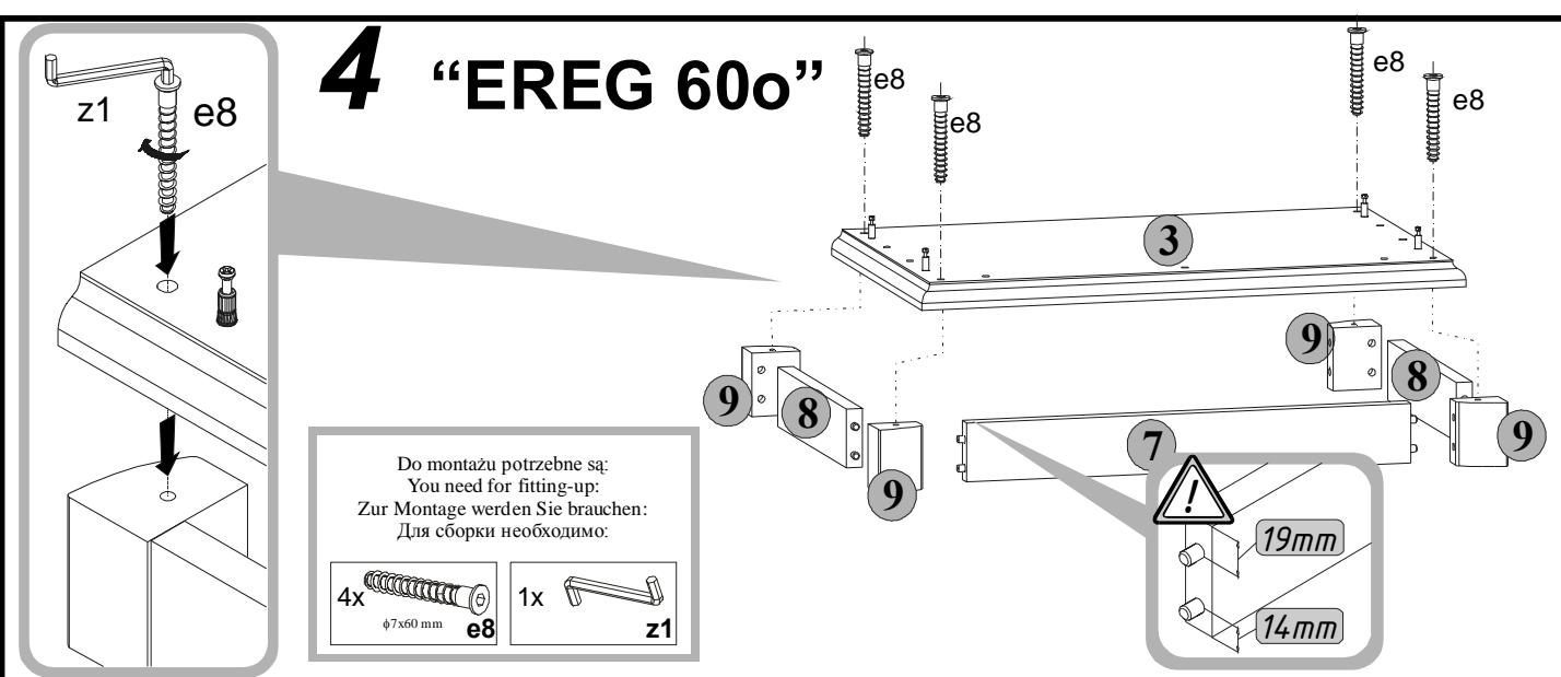
**PL** Złożyć segment zgodnie z rysunkiem i połączyć złączem mimośrodowym **r1**, używając do tego celu kluczyka **z1**.
