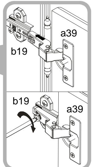
*Regulacja drzwi / Adjustment of door/Türeinstellung/
